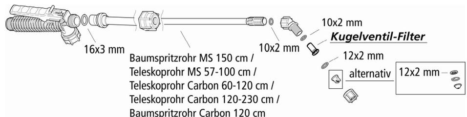
2. Bei Anwendung von Teleskoprohren ist bei befülltem Spritzrohr zu beachten, dass beim Zusammenschieben (verkürzen der Spritzrohrlänge) auch mit eingesetztem Kugelventil-Filter Spritzbrühe an der Düse austritt.
